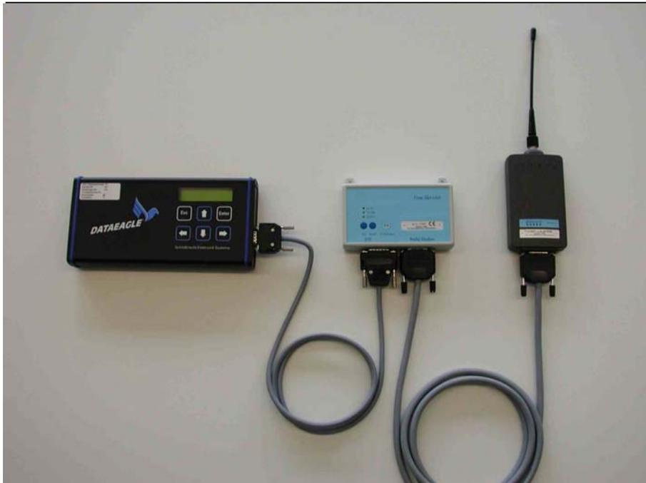
Für eine Übertragungstrecke werden 2 Funkeinheiten benötigt. Es ist der Aufbau eines Funknetzwerkes möglich. Dabei übernimmt eine Funkeinheit die Rolle des Funkmasters. Ein Funkmaster kann bis zu 99 Funkslaves ansprechen. Die Stromversorgung der Komponenten erfolgt über das 15 polige Kabel vom DATAEAGLE aus.
