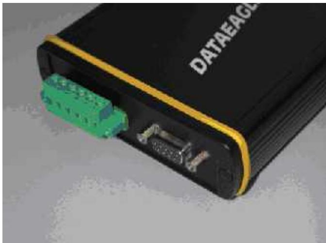
Kommunikationsanschluss für Profibus, MPI und serielle Verbindungen
