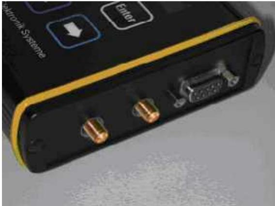
Ansicht DATAEAGLE von der Antennenanschlusseite mit SMA Anschlüssen
