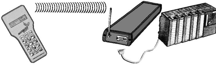
Wir haben die Elektronik des DATAEAGLE in ein handliches Kunststoffgehäuse integriert und zusammen mit der Funktechnik und einem Akku und einer Tastatur erweitert. Diese Gehäuseform nennen wir DATAEAGLE WOPY Serie.
