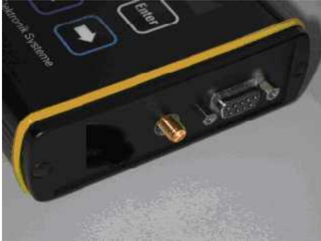
Ansicht DATAEAGLE von der Antennenanschlusseite mit SMA Anschluss
