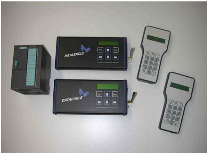
Mehrzellenbetrieb mit mehreren DATAEAGLE WOPY. Beide Geräte buchen sich bei demjenigen Sender ein der den besten Empfang hat. Dieser Zellenwechsel wird automatisch durchgeführt.
