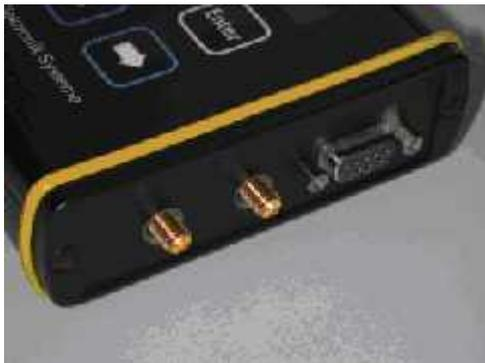
Es müssen immer beide Antennen angeschlossen werden, ansonsten kann es zur Zerstörung der HF Ausgangsstufe kommen. Werden externe Antennen angeschlossen, so sollten die beiden Antennen 20 cm bis 100 cm voneinander montiert werden.
